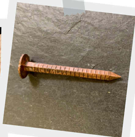
Chaque ardoise est taillée à la main par l'entreprise Guillaneuf couverture puis fixée grâce à des clous en cuivre crantés (plus robustes car ne rouillent pas)
